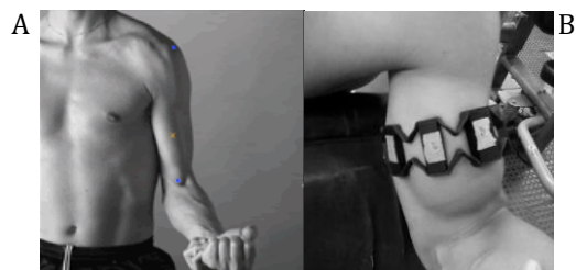
Figura 2: A) Posición de los electrodos según SENIAM. B) Posición del Myo en montaje experimental según SENIAM
